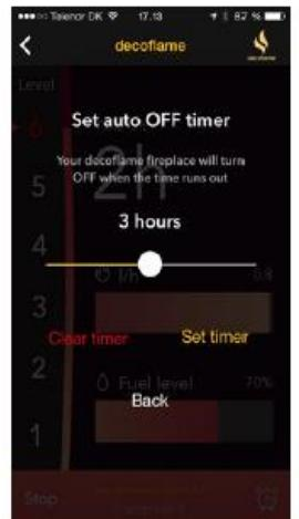
6. Для регулировки интенсивности пламени, выбирайте желаемый уровень в левой части экрана (1 – это самый низкий уровень пламени; 5 – это самый высокий уровень пламени; 6 – это включение режима «**Eco Wave**» экономия расхода топлива до 50%. Запатентованная технология Decoflame.
